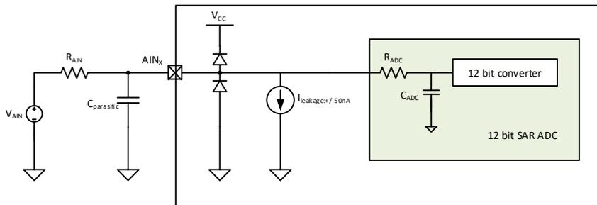
对于 0.5LSB 采样误差精度要求的条件下，外部输入阻抗的计算公式如下：
