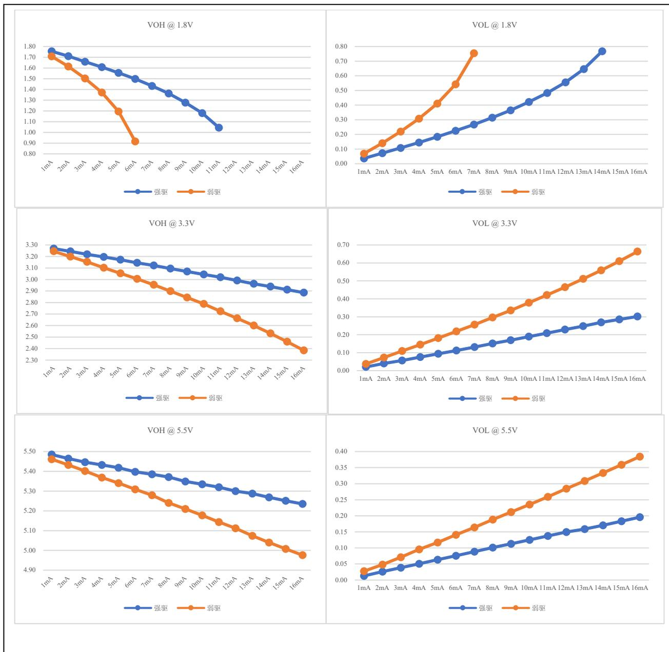
图 7-2 输出端口 VOH/VOL 实测曲线
