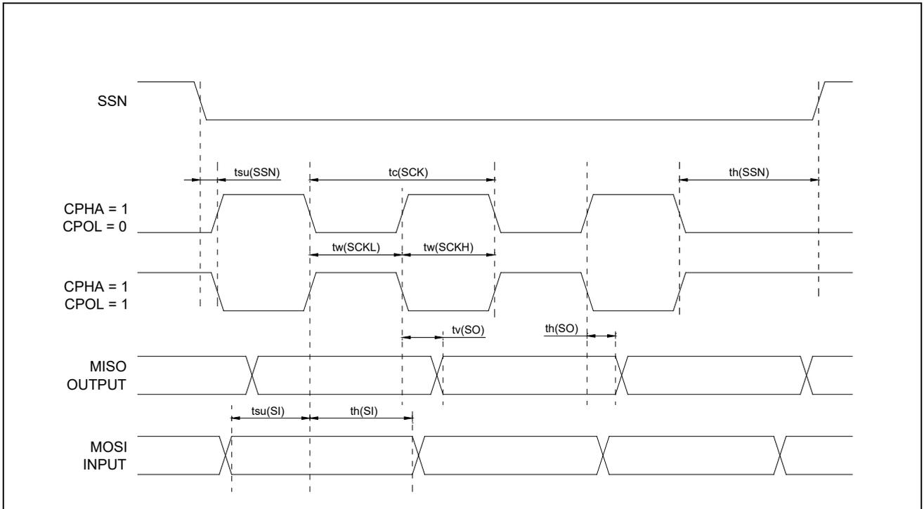
图 7-6 SPI 时序图 (从机模式 cpha=1)
