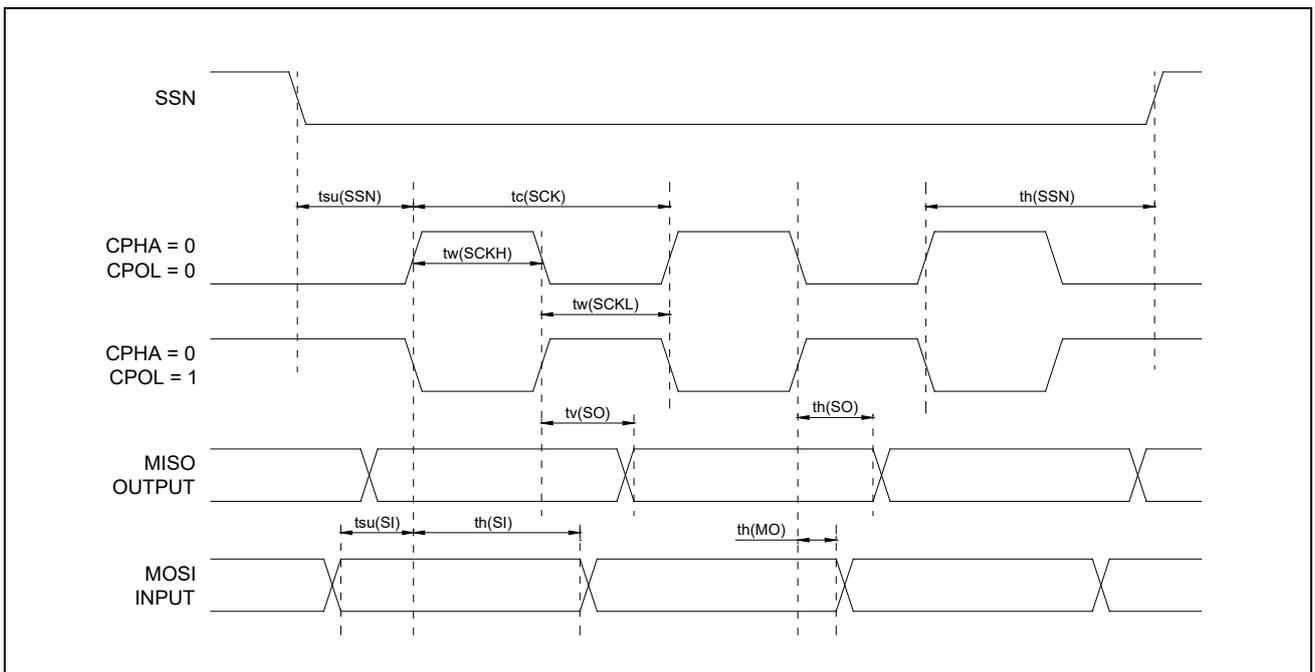
图 7-5 SPI 时序图（从机模式 cpha=0）
