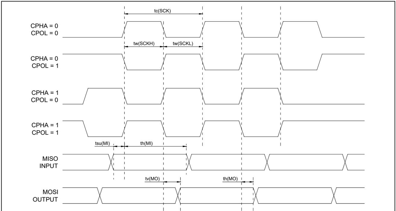
图 7-4 SPI 时序图（主机模式）
